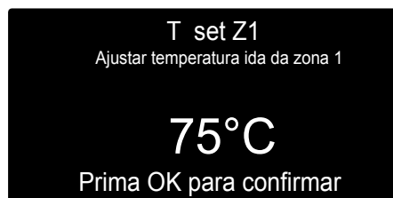
Modificação temperatura água quente aquecimento
